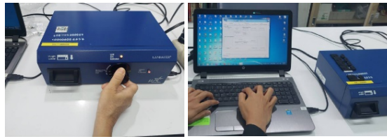
ภาพที่ 2 เครื่องอ่านค่าปริมาณรังสี OSL nanoDot (MicroStar Dosimetry Reader)
